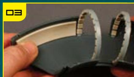
03 На задней части элемента есть два ребра, совпадающих с бороздками в стене коридора. Примерьте элемент, затем приклейте его.
